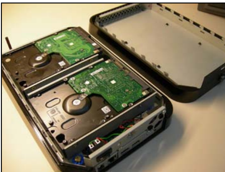
Illustration 126 : Couvercle du disque retiré
