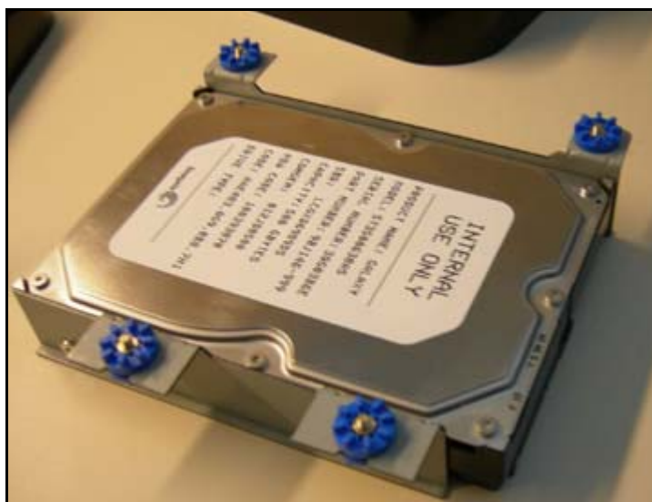
Illustration 132 : Disque interne de remplacement avec supports fixés
