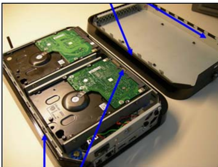
Illustration 135 : Alignement des pattes et des encoches
